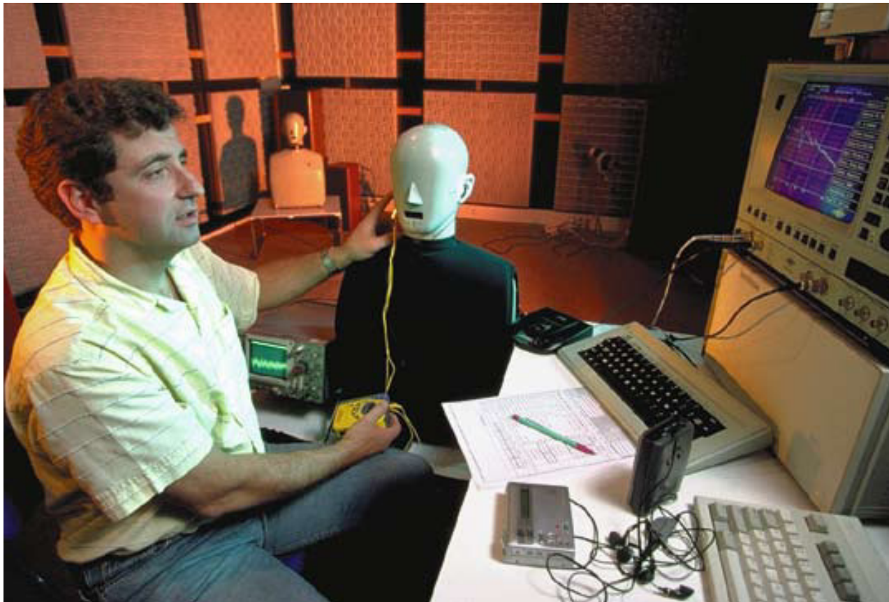
Test de niveau sonore avec « Arthur », mannequin « simulateur de torse » homologué.
